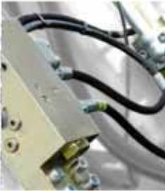
Die Rohrbruchsicherung verhindert im Falle eines Rohr- oder Schlauchbruchs eine unkontrollierte Zylinderbewegung. In einigen Ländern sind Rohrbruchsicherungen gesetzlich vorgeschrieben, wenn mit der Baumaschine Last- oder Hebearbeiten durchgeführt werden.
