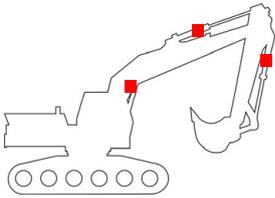
Die Rohrbruchsicherung wird in die abzusichernde Leitung zwischen dem Steuerventil und dem Hydraulikzylinder eingebaut und direkt auf den Zylinder geflanscht. Eine zusätzliche Verrohrung oder Verschlauchung zwischen Rohrbruchsicherung und Zylinder ist nicht zulässig.
