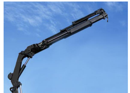
Doppel-Gehäuse: Lasthaltung beider Bewegungsrichtungen
