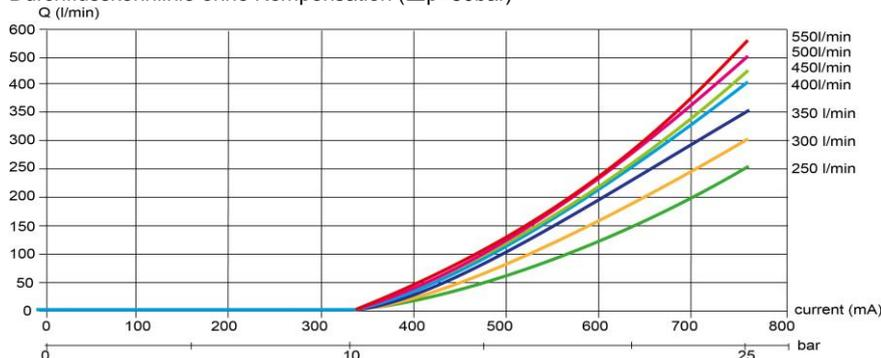
Durch die Kompensation (siehe 4.7) ergeben sich durch die Last geringere Öffnungsquerschnitte als sie aufgrund des Vorsteuerdruckes / Stromes erwartet werden!
