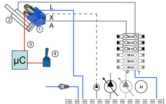
Es wird empfohlen, den X-Anschluß mit einem zusätzlichen im Vorsteuerkreis zu integrierendem Ventil bei Nichtbetätigung der Rohrbruchsicherung drucklos zu schalten.
