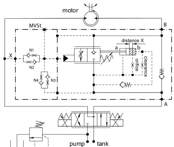
Der Einsatz von Shuttle Düsen gewährleistet ein selbstreinigendes System, wodurch kein weiterer Zulaufilter erforderlich ist.
