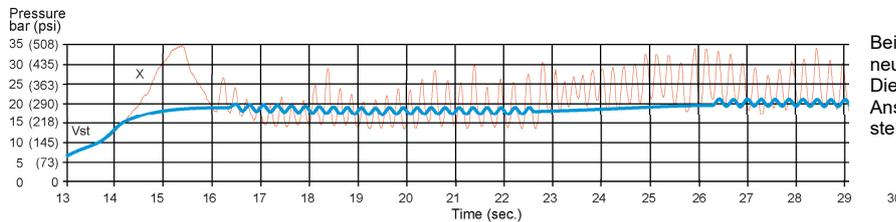
Beispiel einer gedämpften VST Kennlinie vom neuen patentierten Dämpfungsventil. Die vorhandenen Schwingungsamplituden vom Ansteuerdruck werden entsprechend der eingestellten Dämpfung geglättet.
