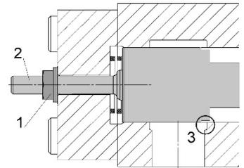
**HINWEIS:** Wenn die Schieberhubbegrenzung zu weit hereingedreht wird, wird im Kraftgang ein unnötig hoher Verlust produziert.
